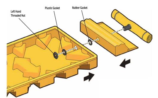
NEVER UNFURL THE BLADDER. IT IS ROLLED UP AT THE FACTORY IN A MANNER TO ASSURE 100% DEPLOYMENT
